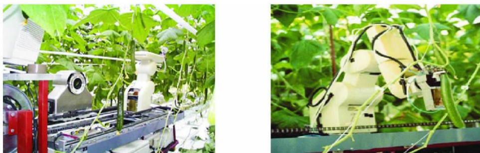
图 15 荷兰农业环境工程研究所研制出的一种多功能黄瓜收获机器人
