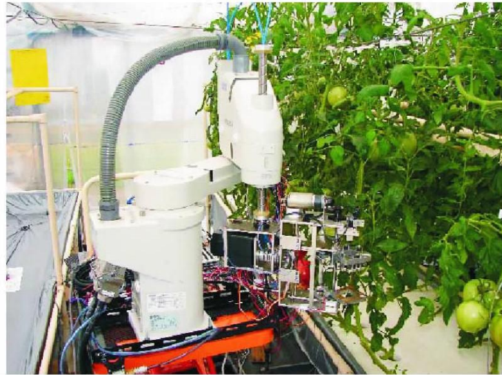
图 13 KNODO N, YATA K 等研制的一种番茄采摘机器人
