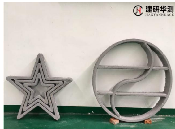
3D 打印混凝土成品图
